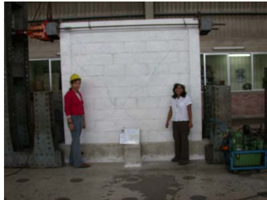
Figura 10. Ensayo del muro 1 a carga lateral cíclica.
