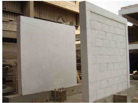
Figura 8. Muros M1(derecha) y M2 (izquierda) culminados antes del ensayo
