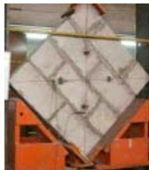
Figura 3. Ensayos en pilas (a) y muretes (b)
