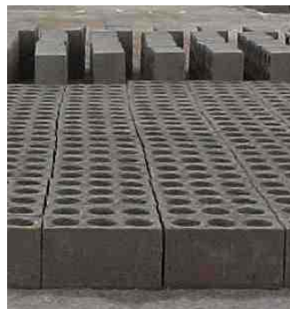
Figura 1. Bloques de concreto artesanal
