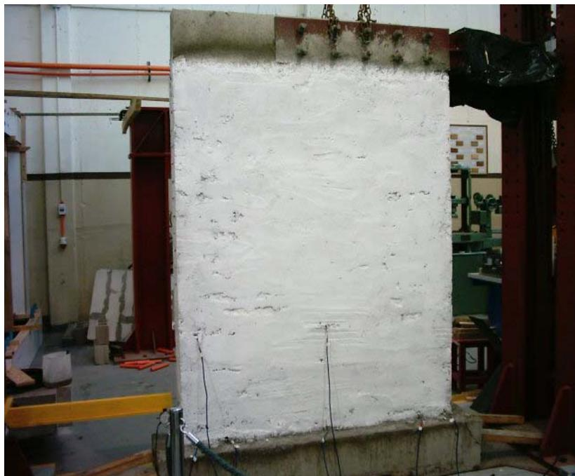
Figura 3.5: Muro N°3 con instrumentos instalados para ensayo
