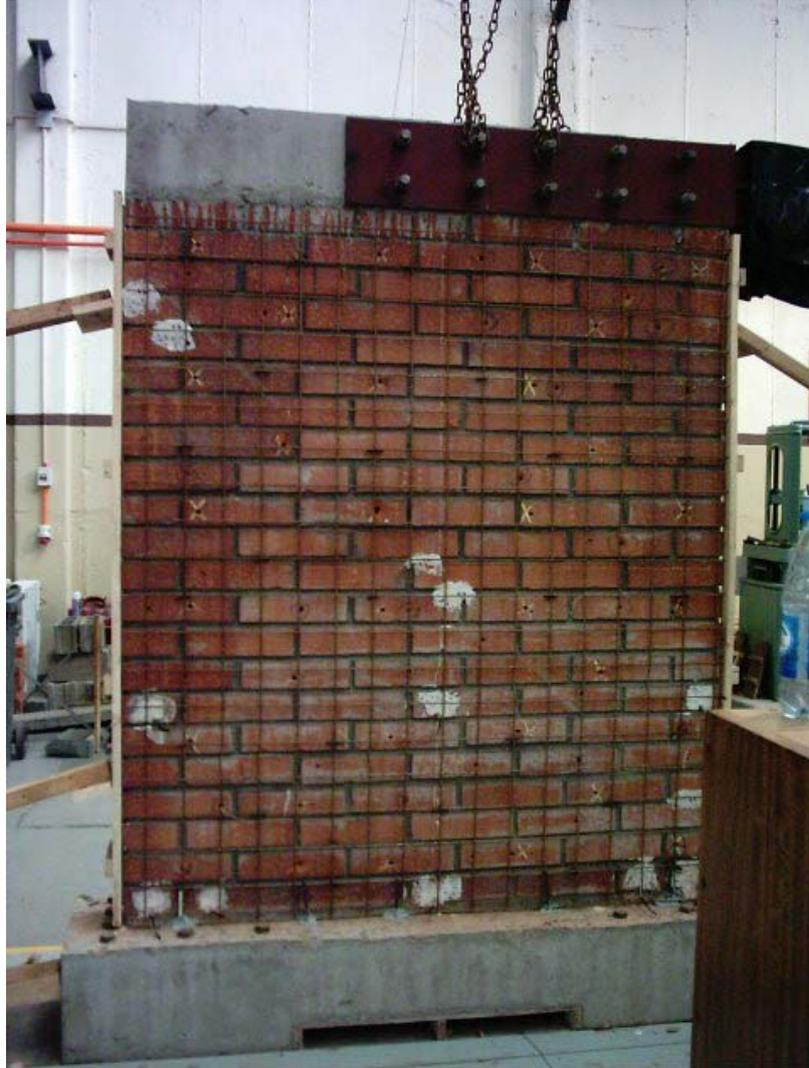
Figura 3.3: Muro N°4 con Malla Acma instalada
