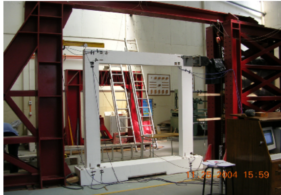
Fig. 4.1. Pórtico Instalado en Marco de Reacción
